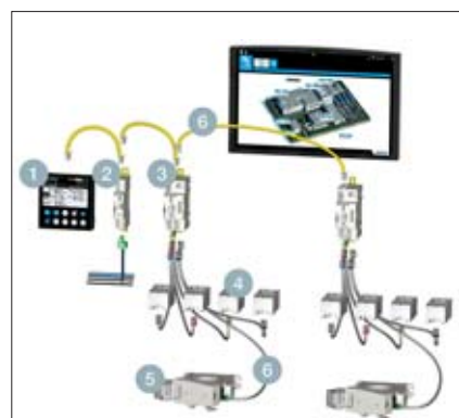
Bild 4: Die Differenzströme I_{\Delta} und I_{PE} an der Haupteinspeisung sind identisch – es kann ggf. genügen, den im PE fließenden Strom I_{PE} zu messen
